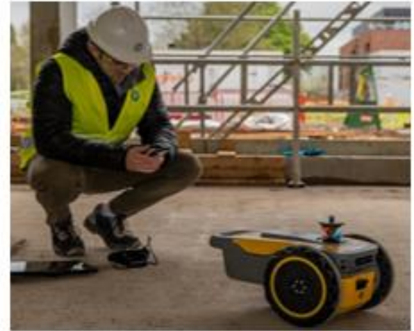
建築現場の床に直接設計図をプリントする自走式ロボット「 HP SitePrint 」
