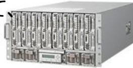
電源や冷却ファンを数枚のブレードで共有するなど、故障の発生しやすい部品点数を削減できるため、障害発生率の低下、電力効率の向上、配線の取り回しなどの保守面で優位性があります。更に、多くの機種ではサーバ群の一括管理機能を実装しており、故障したブレードを無停止で交換したり、サーバの負荷状況、故障状況に応じて、予備のシステムに自動切換えを実施できるものも存在するなど、システムの信頼性向上、保守性向上といった効果も期待できます。
